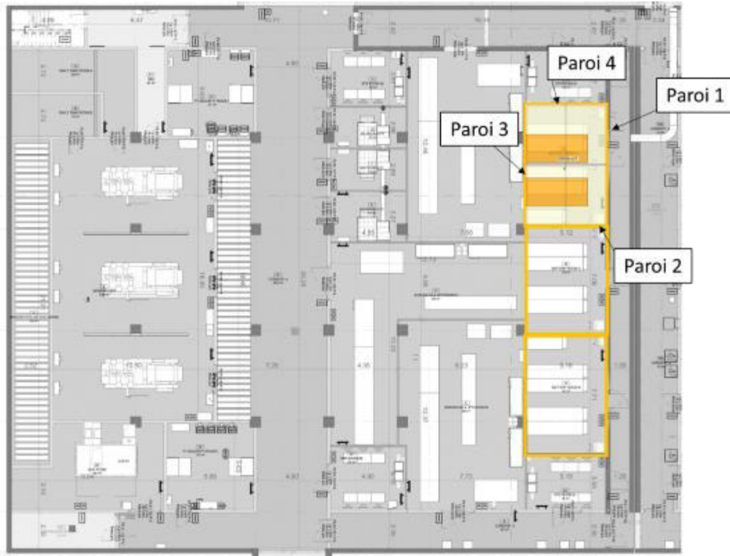
Figure 48 : Schéma d'un local batterie et localisation des parois – PhD n°11
